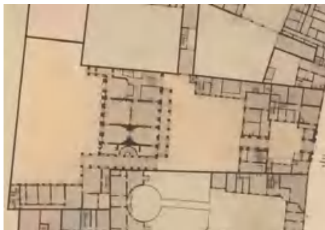
fig. 10 – Planimetria di primo Ottocento raffigurante lo scalone d’onore dell’hôtel de Galliffet costituito da una rampa con andamento curvilineo (AN – Paris, Atlas Vasserot (1810-1836), 10e arrondissement, quartier Saint-Thomas d’Aquin, bloc n. 11, F/31/92/25 ©Archives Nationales de France, Archives de Paris).
