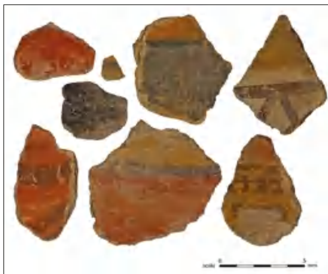
fig. 1 – Macrofotografia di alcuni frammenti di intonaco del gruppo B.
