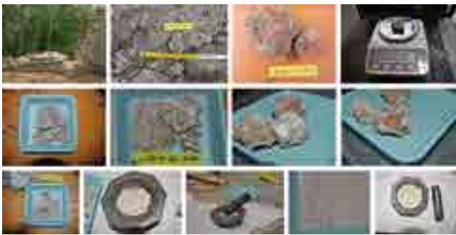
fig. 1 – Disgregazione delle malte: dal prelievo del campione alla polvere di legante.
