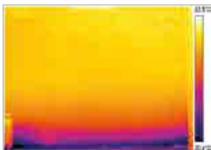
fig. 2 – Rilievo IR: acquisizioni termografiche pre-riscaldamento. \Delta T : 3,1^{\circ}\text{C} .
