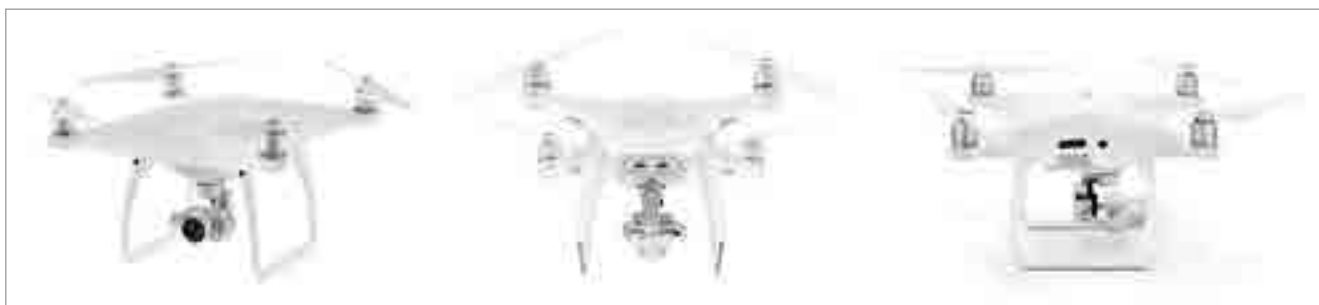
fig. 1 – Alcune inquadrature dell'APR Phantom 4 DJI in cui è visibile la dotazione montata a bordo: camera fotografica e gimbal .
