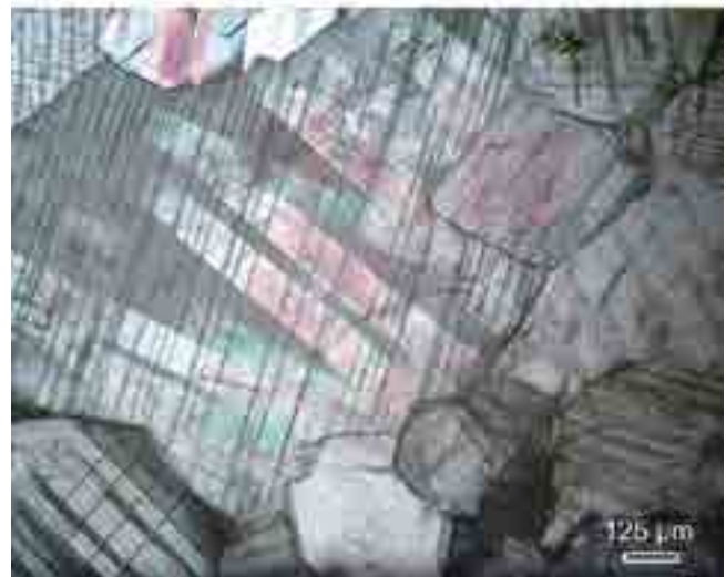
fig. 4 – SG13 A3 3001L Rocca metamorfica di natura carbonatica/dolomitica riconducibile alla formazione delle Dolomie di Monte Rossotta, presenta una struttura microspatica con cristalli spatici. All'ingrandimento maggiore sono ben visibili i cristalli di dolomite. I cristalli di dolomite hanno una dimensione massima di circa 1 mm, che spiccano nell'omogeneità totale dei cristalli che hanno una dimensione nettamente inferiore (circa 0,1mm).
