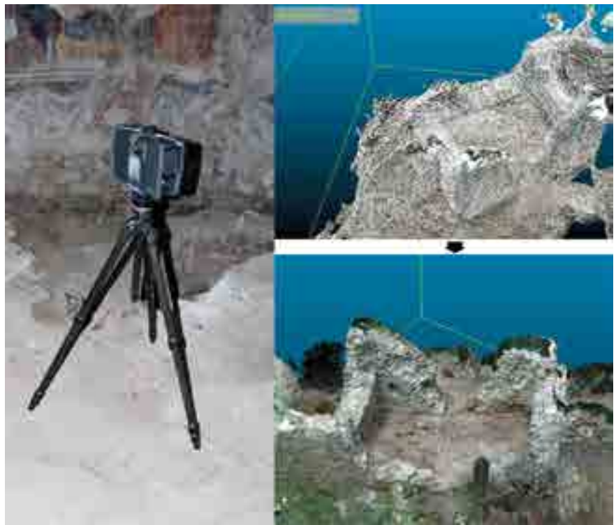
fig. 1 – Laser scanner per la documentazione 3D e il rilevamento della torre. Rielaborazioni grafiche eseguite sul software di modellazione.
