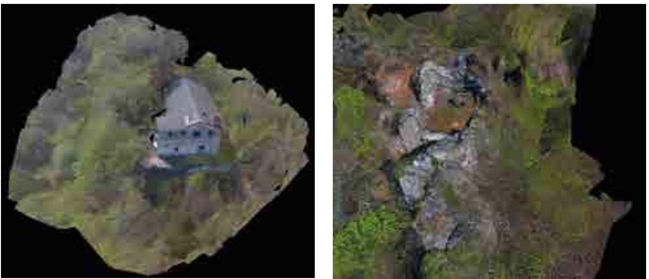
fig. 10 – La mesh con texture a sinistra della Chiesa di Santa Giulitta e a destra della torre.
