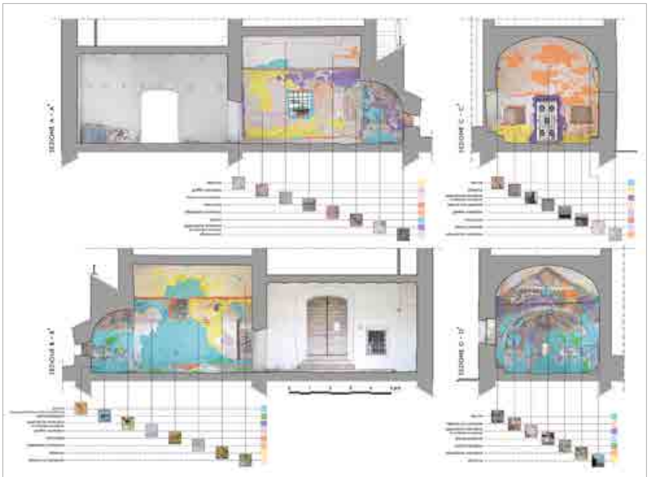
fig. 19 – Mappature delle patologie secondo norma UNI 11182/2006 (F. Bergamini, V. Polia, R. Vignuolo).
