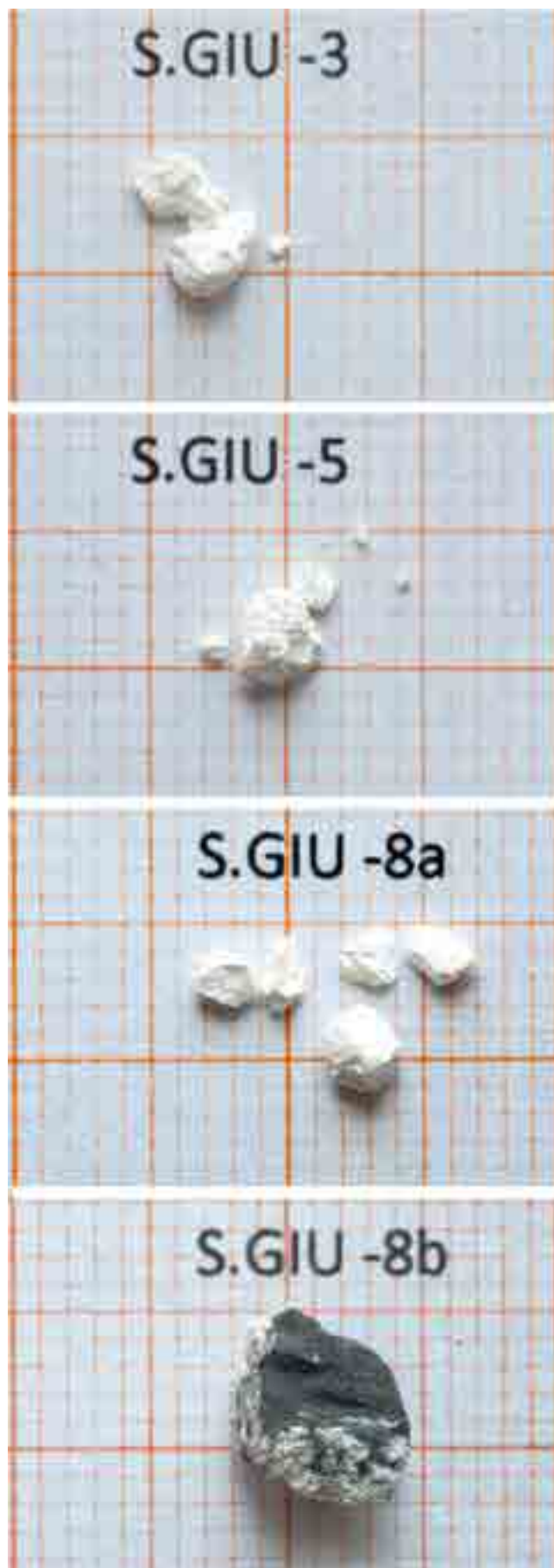
fig. 8 – Campioni n. 3, 5, 8a e 8b isolati dalla malta e preparati per la datazione del radiocarbonio. I campioni 3, 5 e 8a sono grumi di calce mentre il campione 8b è un carbone di legna.
