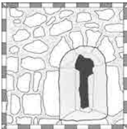
figg. 35-36 – Campione “E” 1m x 1m di tessitura muraria esterna, abside della cappella.
