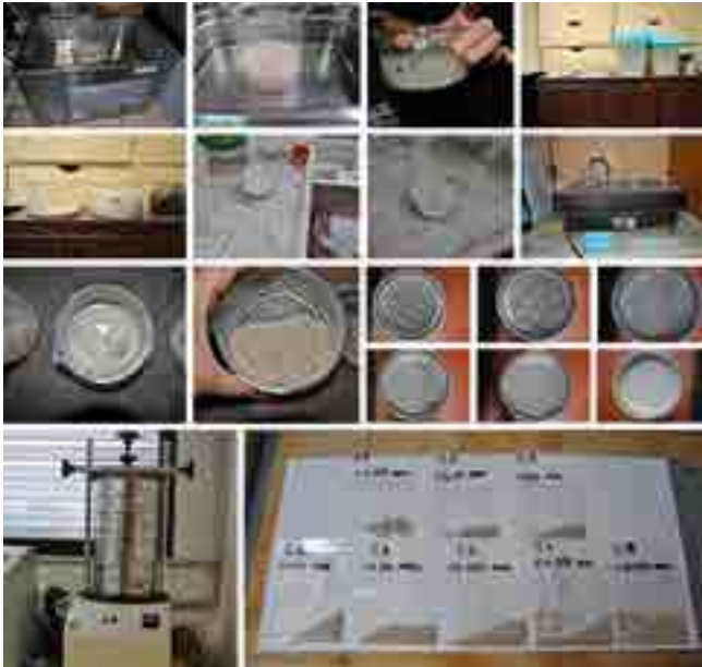
fig. 2 – Analisi granulometriche: dalla preparazione del campione ai risultati.
