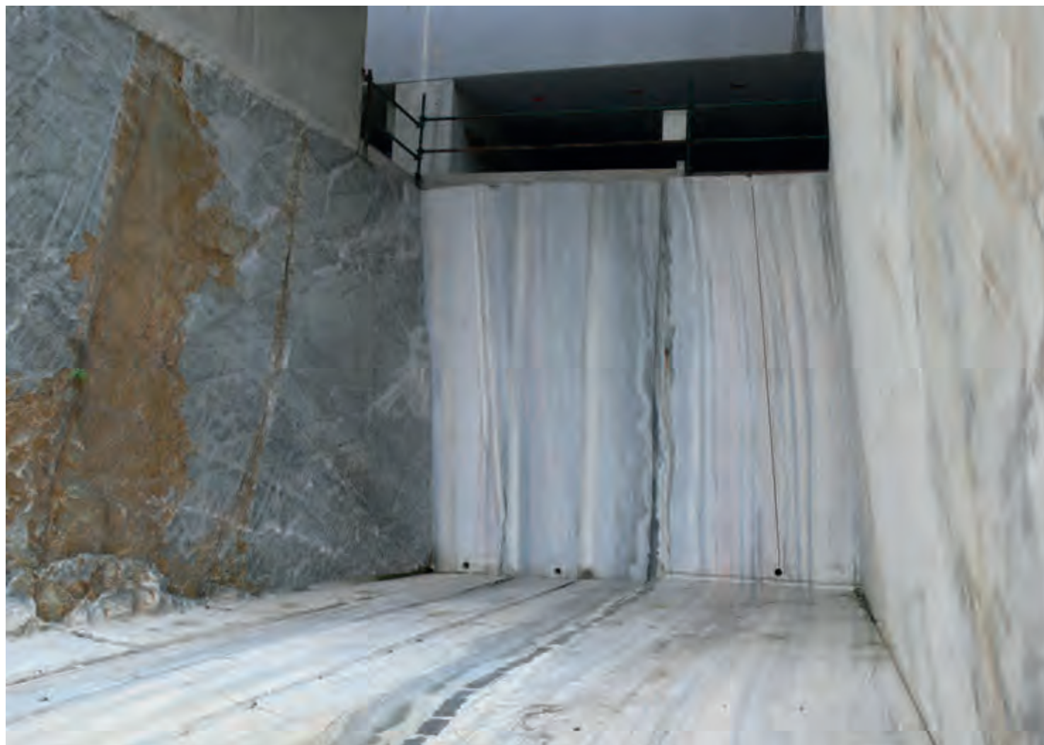
Fig. 10.2 La bancata di marmo di Candoglia all'interno della cava. Le vene verticali indicano la giacitura del sistema geologico dell'area; quelle più scure vengono eliminate in fase di riquadratura dei blocchi, per valorizzare la varietà dal caratteristico colore bianco rosato.
